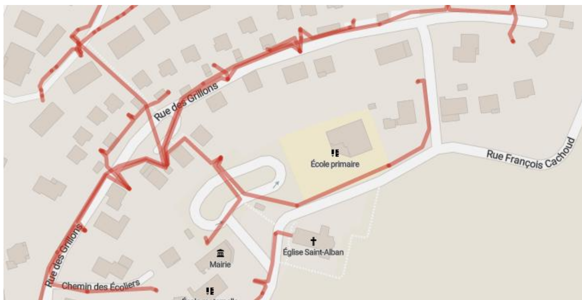
Réseau BT souterrain ENEDIS près de l'école de St-Alban de Montbel
